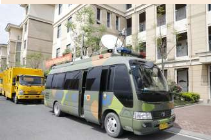
应急指挥车以卫星通信实现事故现场与指挥中心实时音视频互通
