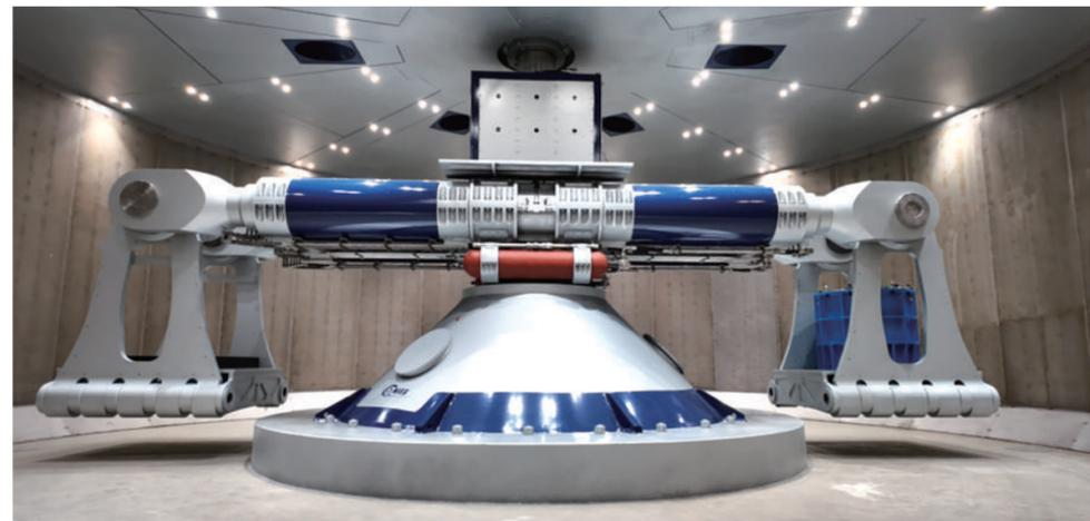
“在这一超重力环境下,1米高的模型土箱等效于100米深的地层,1小时实验可以完成长达400多天的地质变迁,1克炸药能模拟1吨TNT的爆炸当量。”主机组组长汪玉冰分别举例说明了超重力模
