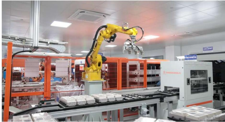
有DIP(双列直插式封装)及整机等29条全自动生产线,形成了日产5万只智能电能表的生产能力。根据日产能核算,仅需0.72秒就能完成一只电能表的制造,生产效率得到了质的飞跃。
